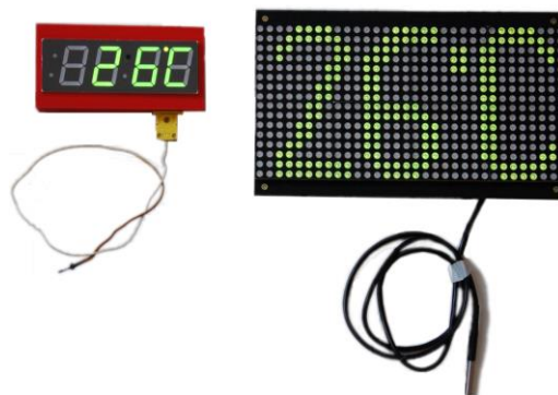
Obr. 3 - Dvě verze demonstračního teploměru - výška displeje 3 a 12 cm, rozsahy -100 až 1400 °C a - 55 až 120 °C
