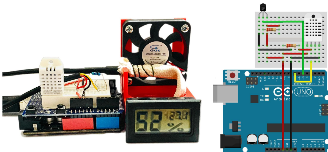
Obrázek 3.22: Realizace a schéma kombinovaného teploměru.
