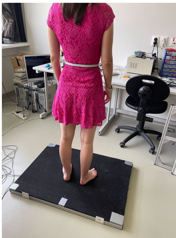
Obrázek 1.20: Osoba měřená na sestavené dlaždici osazené čtyřmi tenzometry.
