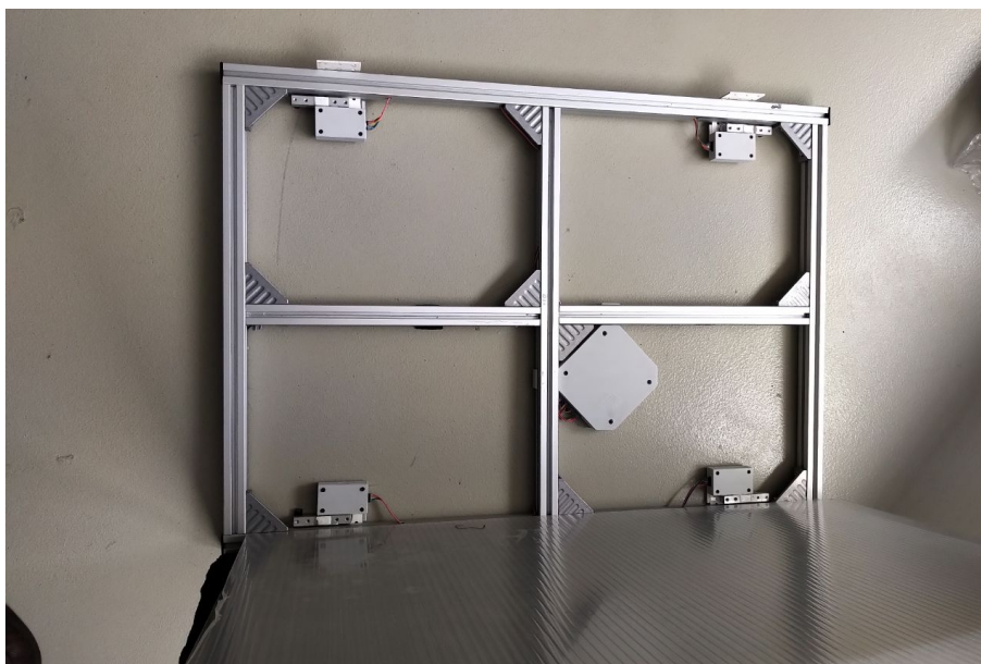
Obrázek 3.11: Měřicí podložka obsahující čtyři tenzometry.
