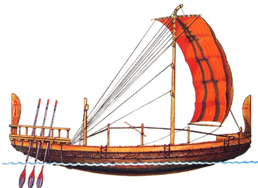
Obr. 6: Námořní loď ze starověkého Egypta – ze Staré říše (asi 2 550 let př.n.l.); typická délka byla 14 m až 20 m, šířka 2 m až 5 m, pohon vesly a větrem; podoba lodí je známá z kreseb v hrobkách faraónů a ojediněle i z vykopávek (zdroj [12])
