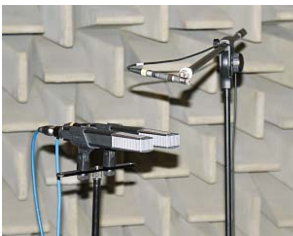
Obr.14 Dvojice snímačů Sennheiser MD441U s referenčním mikrofonem Brüel & Kjær
