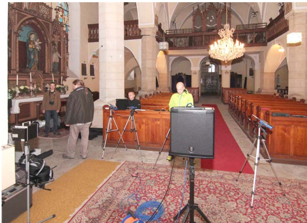
Obr.4 Příprava akustických měření v kostele sv. Voršily
