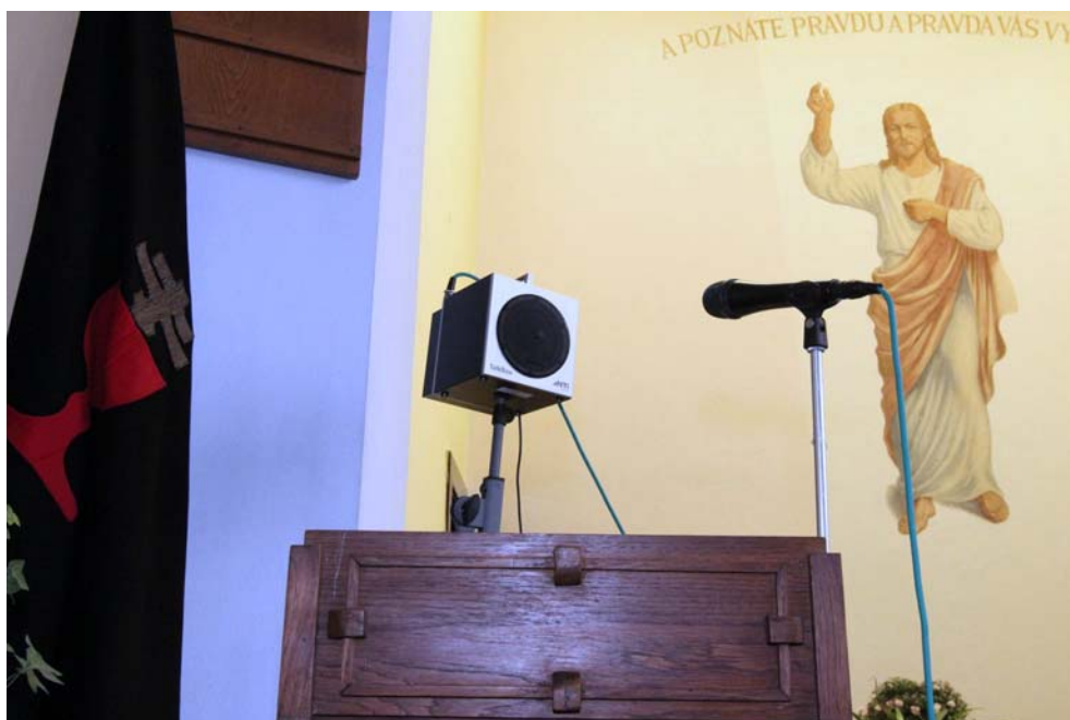
Obr.7 Referenční zdroj NTi TalkBox na kazatelně Husova sboru při měření přenosových vlastností ozvučovacího systému
